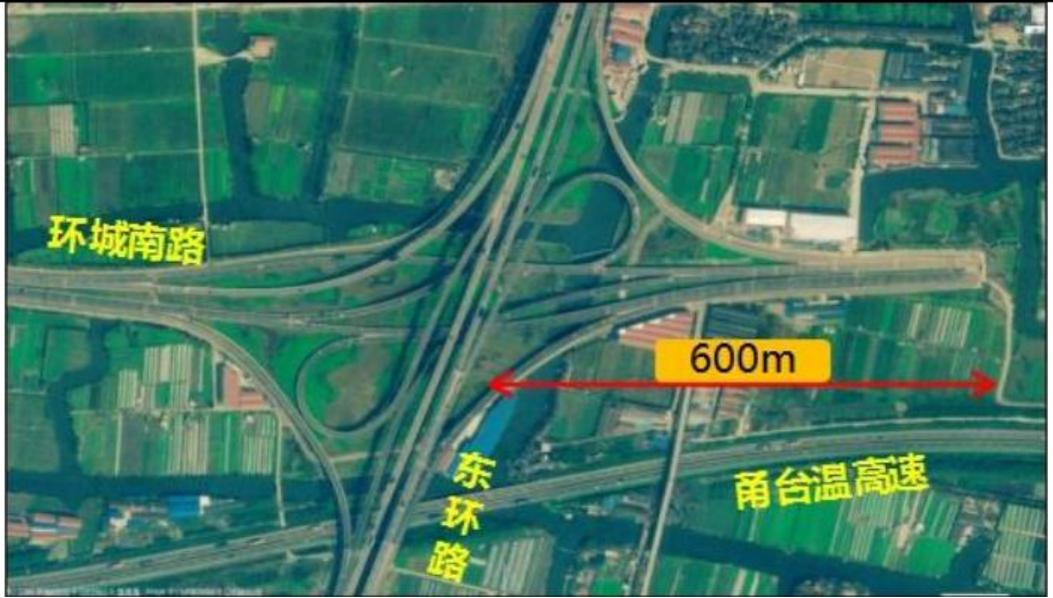
现状环城南路道路等级为快速路，现状宽度为 68 米。路段设主线双向 6 车道加辅道双向 6 车道。高架车速限速 80km/h，地面道路限速 50km/h。
